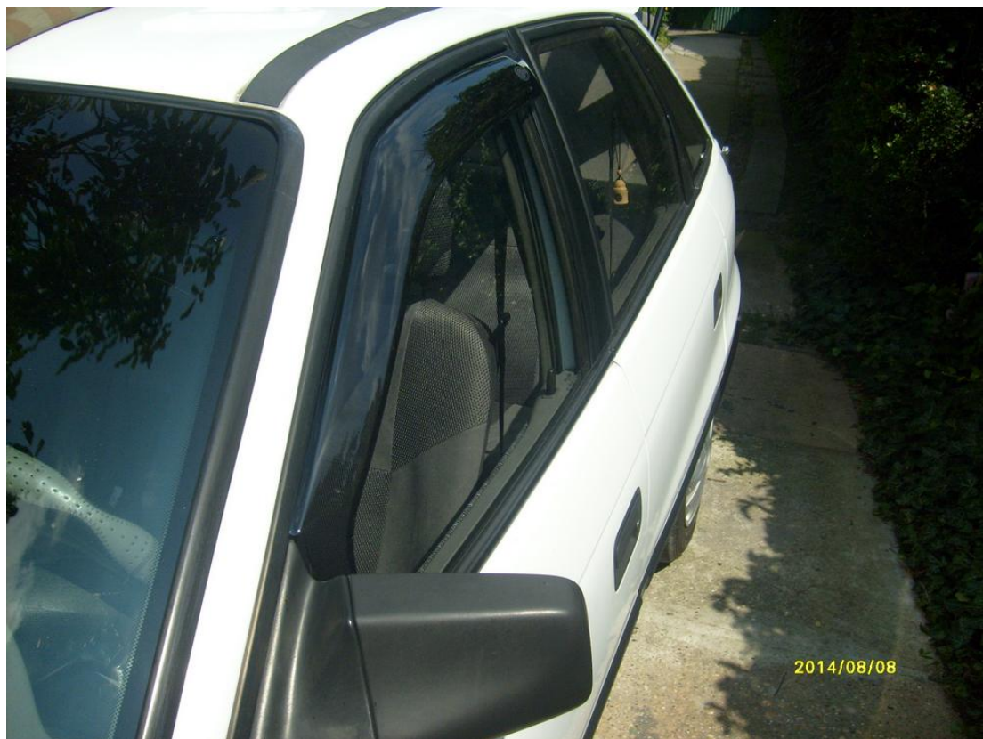
2. kép Felszerelt állapotban a légterelő (ablakgumik alá beszorítva)
